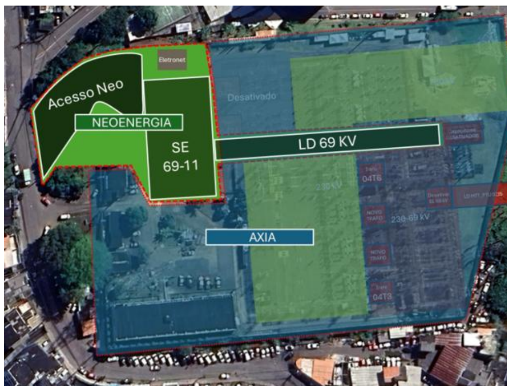
Figura 3-4 – Proposta final da configuração da SE Matatu contemplando a nova SE Matatu II e obras para acesso independente às duas subestações.
